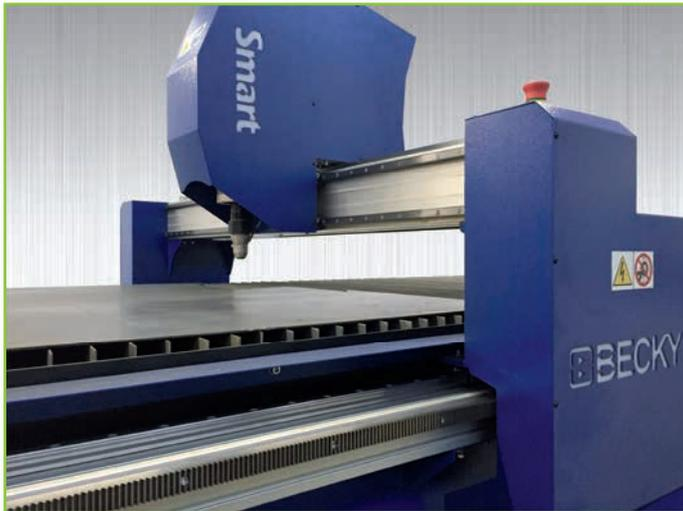
Portale del tipo Gantry con Motori Brushless su entrambi i lati dell'asse X e riduttori di precisione, motore Brushless sull'asse Y e riduttore di precisione.
