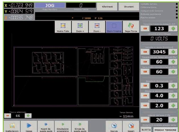
Il software di programmazione offerto di serie con il modello Smart si contraddistingue per facilità e velocità di apprendimento e di realizzazione delle lavorazioni sfruttando una ricca biblioteca di figure parametriche con profili grafici che richiedono il semplice inserimento delle dimensioni.
